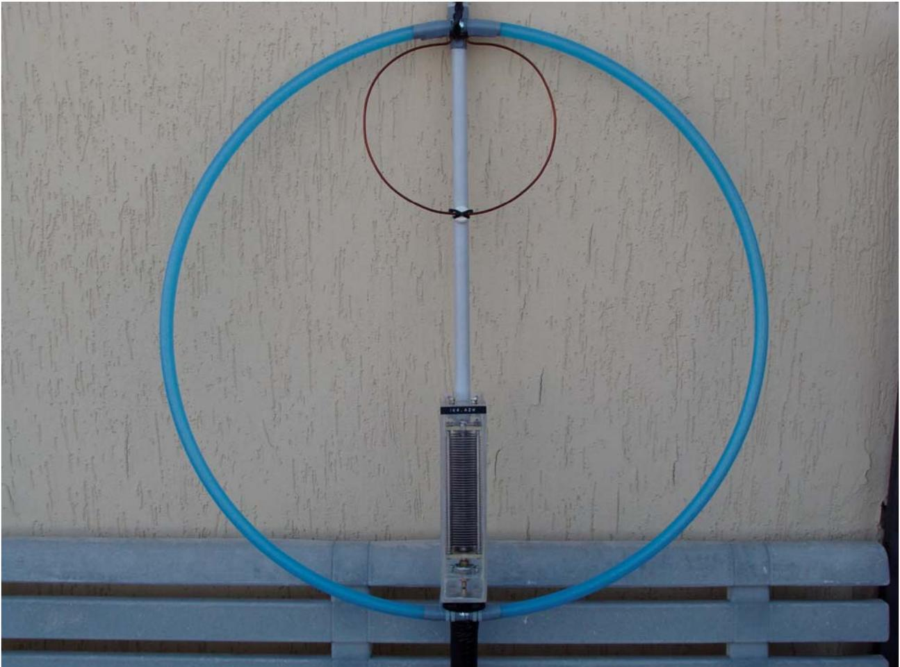
Io per la spira grande ( il rame che ho messo dentro l'hula hop ) ho usato il conduttore centrale di un vecchio cavo Pope H 100 che è simile al 5020 o ad altro cavo semirigido di comune uso radiantistico. Per la spira piccola si può usare lo stesso filo di rame rigido o uno similare di rame smaltato di circa 2,0 2,5 oppure 3,0 millimetri. ( influisce poco ).
